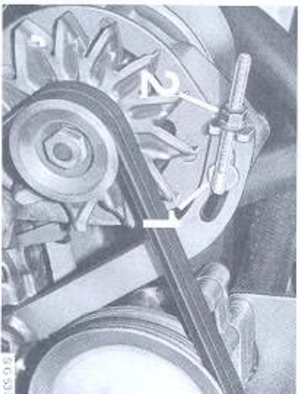
Vérification de la tension de la courroie
