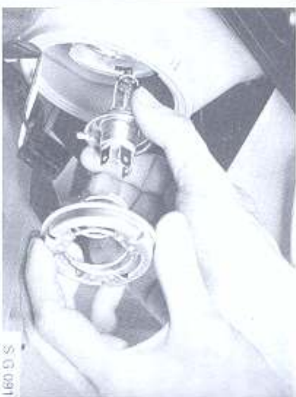
Remplacement d'ampoule, phares
