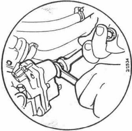
c Raccorder les flexibles d'essence vers la soupape de pression de commande.
