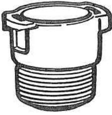
8394 140 Adapteur pour le contrôle du bouchon à pression.
