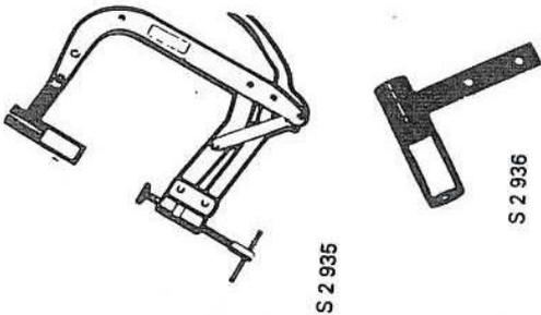
83 93 761 Etau à ressort de soupape, outil KD type 308, utilisé conjointement avec le serre-ressort 83 93 779.
