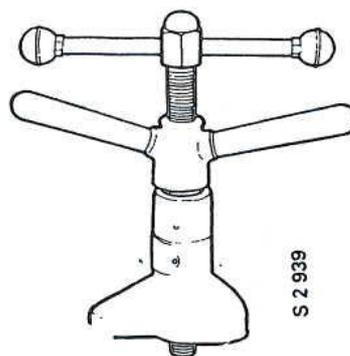
8393803 Outil de montage, joint de guide de soupape.
