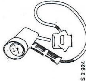
83 93 985 Mesureur de tension de courroie.
