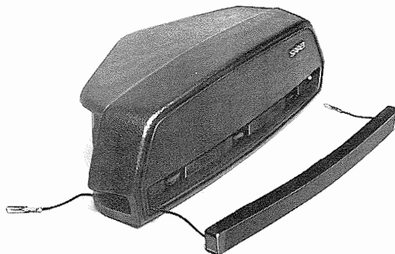
Contact d'avertisseur démonté du rembourrage, ancienne exécution
