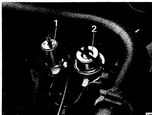
Soupape magnétique et régulateur de pression
