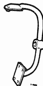
83 92 169 (A2) Support, moteur, pour bâti sur pied
