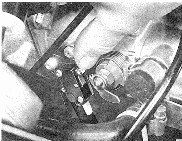
LE BRAS DE MANOEUVRE DU CONTACT DE PAPILLON EST ENFONCE
